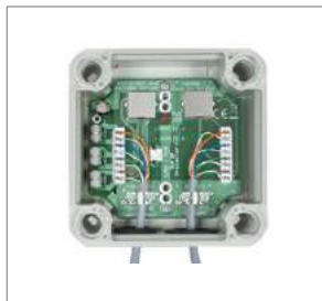
Спосіб укладання і підключення проводів в роз'єми Krone
