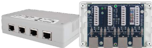
Один модуль PTU або PTF змонтований в корпусі ABS
